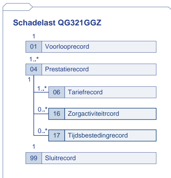
Figuur 5-1 Logische bestandstructuur QG321
